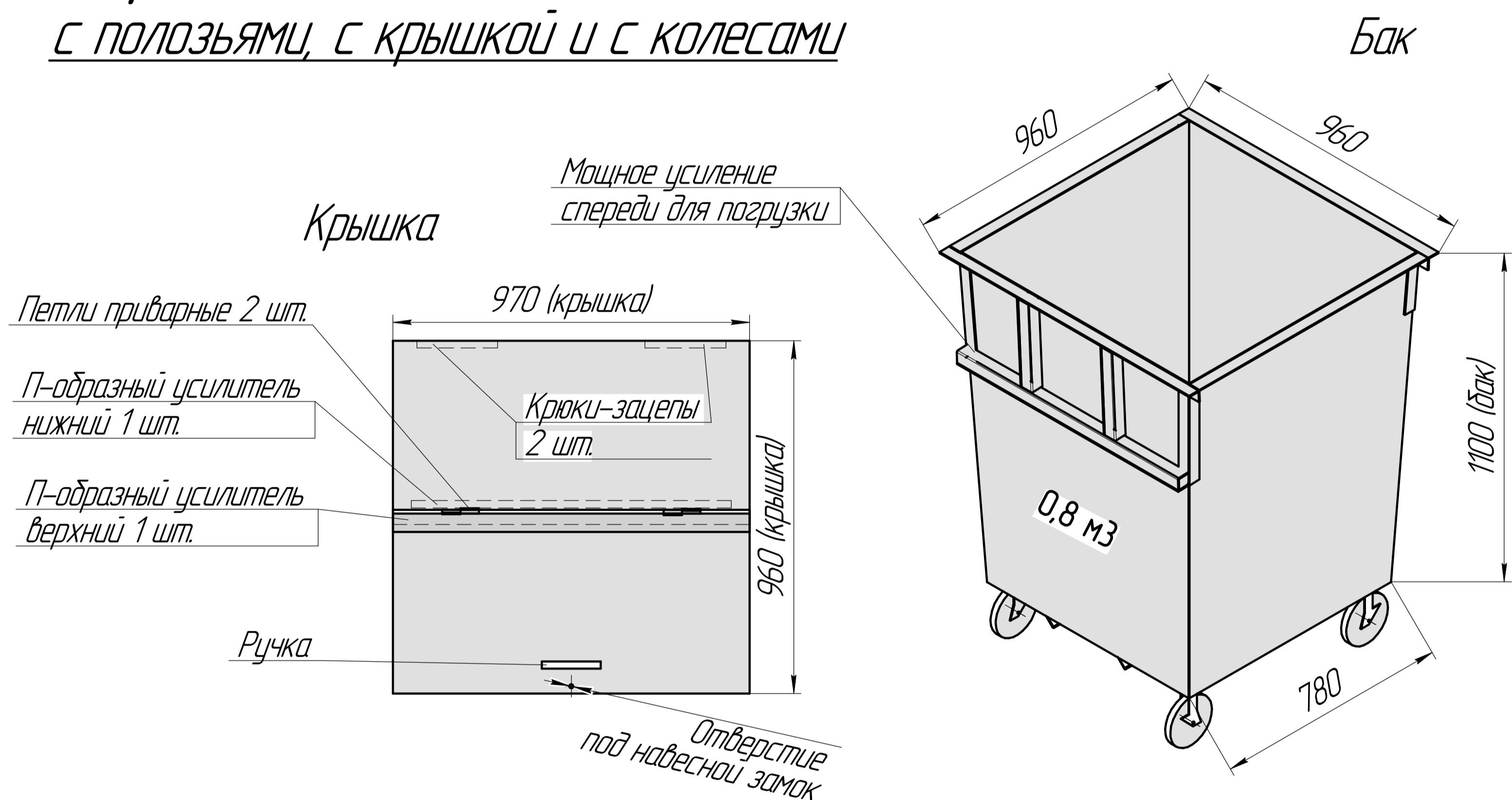
\* Крышка складывается на 2 половинки, перевставляется на 4 стороны, в ней и уголке есть отверстия под навесной замок
